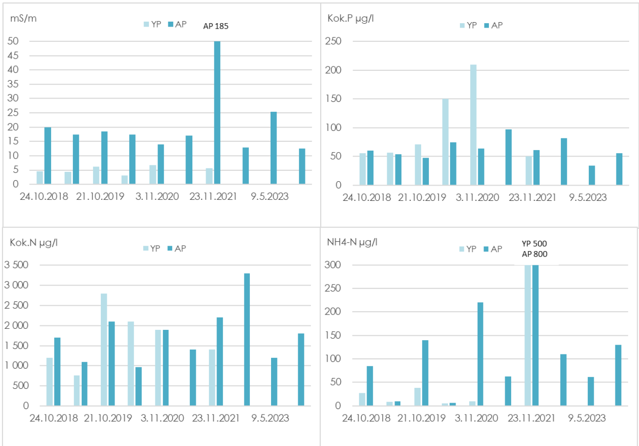
Kuva 4.1. Sähkönjohtavuus ja ravinnepitoisuudet kaatopaikan ylä- ja alapuolisessa ojassa havaintoajankohdittain vuosina 2018–2023. Yläpuolisesta ojasta ei saatu näytettä kevään 2018 ja 2021 havaintokerroilla, lokakuun 2002 havaintokerralla eikä vuoden 2023 kummallakaan havaintokerralla.
